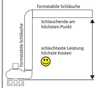
Verringern Sie die Auslasshöhe des Schlauchendes für mehr Pumpleistung.
