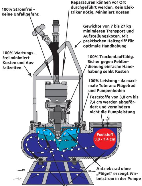
Wirbelstrom drückt Feststoffe an Pumpenrand. Schmutzwasser mit abrasiven Bestandteilen kommt kaum in Berührung mit Pumpenrad. Dies vermindert entscheidend den Verschleiß und die Unterhaltskosten.
